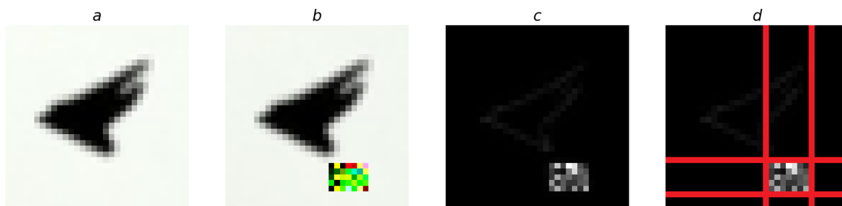
Рис. 3. Пример работы алгоритма: a – оригинальное изображение, b – искаженное изображение, c – матрица оценок аномальности пикселей, d – обнаруженные границы
