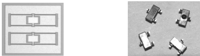
Рис. 2. Фотографии кристалла pHEMT транзистора и применяемых для сборки пластмассовых корпусов для поверхностного монтажа SOT - 23
