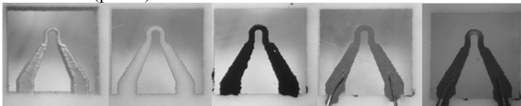
Рис. 1. Этапы изготовления микронагревателя. Слева направо: чип микронагревателя после гравировки; лицевая сторона микронагревателя после гравировки; нагреватель с нанесенной платиновой пастой; отожженный нагреватель; нагреватель в рабочем непрерывном режиме при температуре 650 градусов Цельсия.
