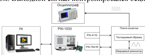
Рис. 1. Структурная схема системы управления микросхемами прямого цифрового синтеза
