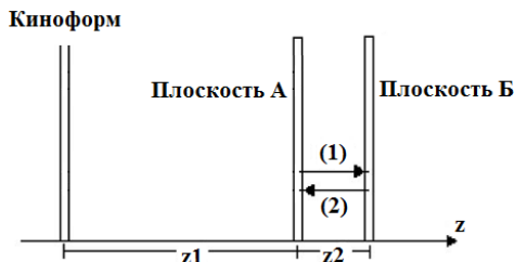
Рис. 1. Схема синтеза киноформов объемных сцен методом «пинг-понг»
