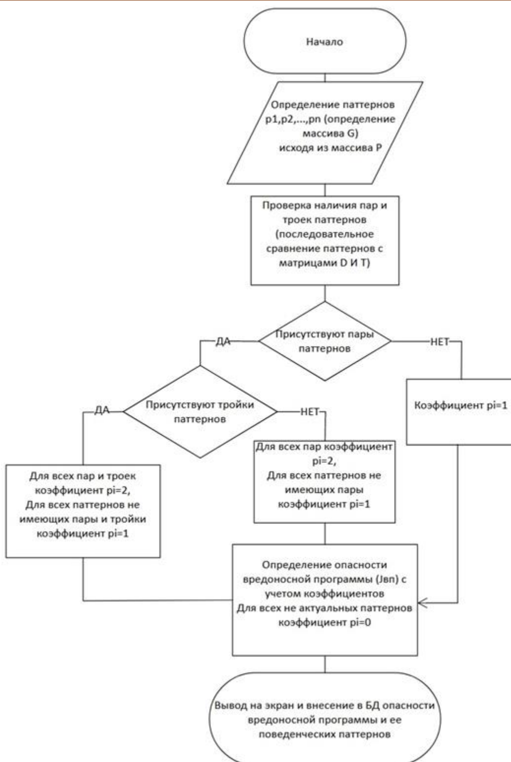
Рис. 2. Алгоритм вычисления значения опасности вредоносных программ Fig. 2. Algorithm for Calculating the Malware Danger Value
