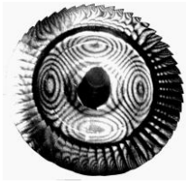
Рис. 1. Интерферограммы колебаний диска
