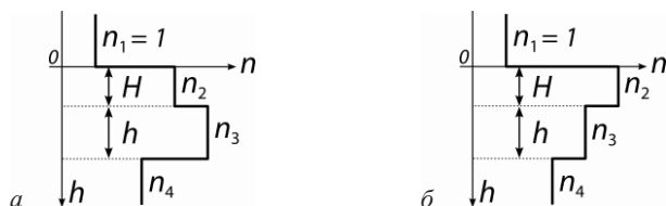
Рис. 1. Профили показателя преломления ПВС I (а) и ПВС II (б)
