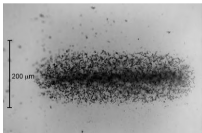
Рис. 2. Микроскопическое изображение экспонированной области с продуктами фототрансформации гетеронаноккомпозитов через два часа после засветки, видно пространственное разделение компонент
