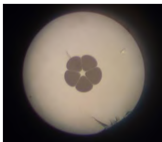
Рис. 1. Фотография микроструктурированного ОВ с синтетической сердцевиной
