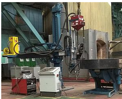
Рисунок 2 – Установка для автоматической кольцевой наплавки
