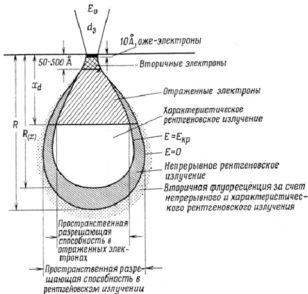
Рис. 15. Схема взаимодействия электронного пучка с массивным образцом в РЭМ с указанием областей генерации сигналов
