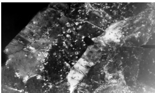
Рис. 5. Темнопольные слабопучковые ПЭМ изображения радиационно-индуцированных преципитатов ( а ) и дислокационных петель ( б ) в облученной стали корпуса реактора ВВЭР [42]
