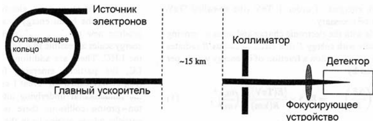
Рис. 5.5. Схема части e^-e^+ линейного коллайдера, предназначенной для ускорения электронов. Аналогичные элементы используются для ускорения позитронов
