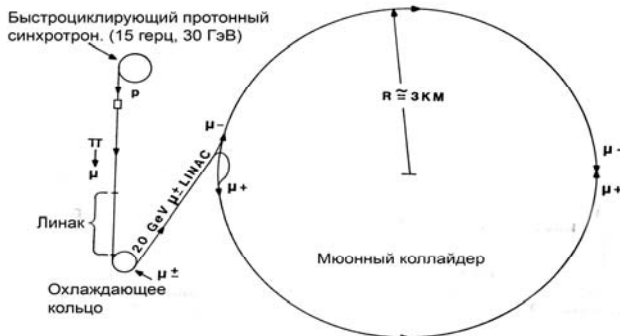
Рис. 5.9. Схема мюонного коллайдера
