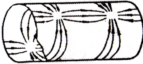
Рис. III.3.3. Картина токов в стенках волновода круглого сечения
