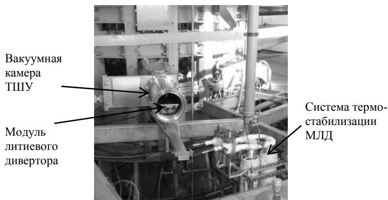
Рис. 3. Стенд тепло-гидравлических испытаний макета модуля с теплоносителем Na-K
