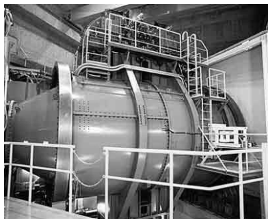
Рис. 7.17. ГАНТРИ со стороны машинного отделения (Япония, Мицубиси)
