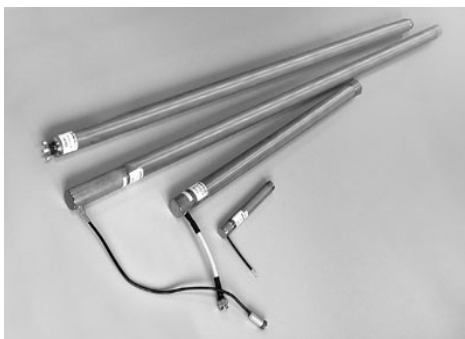
Рис. 7.8. Фотография газонаполненных нейтронных детекторов
