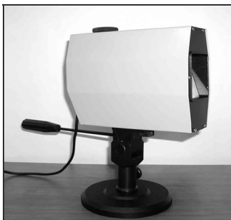
Рис. 3.5. Общий вид тепловизора ТВ-04 «Кст»
