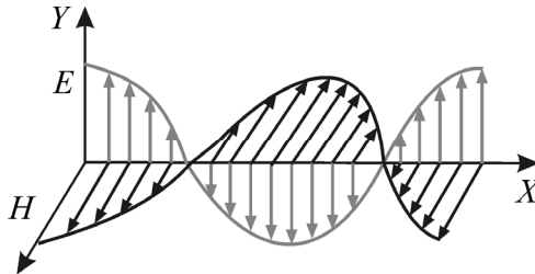
Рис. 1.1. Схема плоской электромагнитной волны
