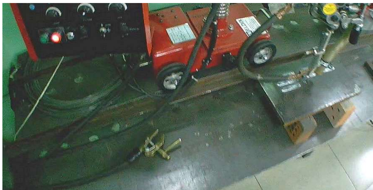
Рисунок 2 – Выполнение наплавки на сварочном тракторе Weldix
