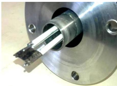
Рисунок 1 Внешний вид зонда, установленного на токамаке Т-11М
