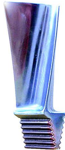
Устройство лопатки турбины
