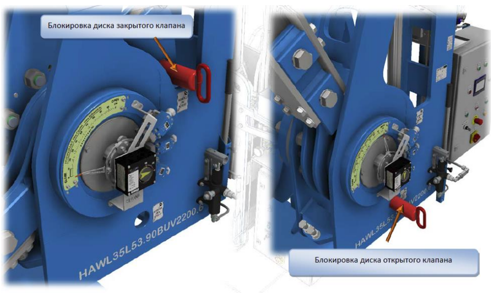
Блокировка комбинированного затвора в закрытом и открытом положении
