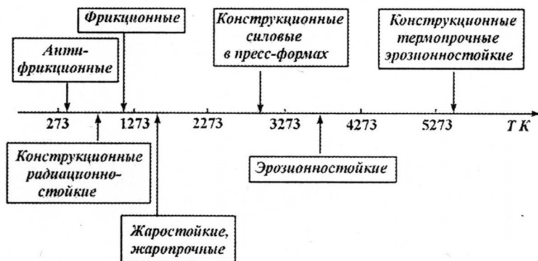
Рис. 2.15. Основные свойства и области применения углерод-углеродных композитов в зависимости от температуры
