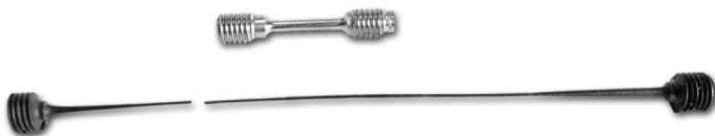
Рис. 5.5. Сверхпластичность быстрозакаленного жаропрочного никелевого сплава типа Ж6У (исходное состояние и после испытания на растяжение при температуре 1100 °С)
