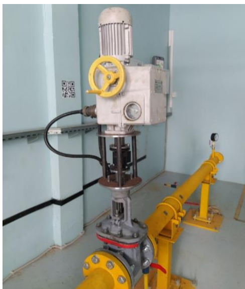
Рисунок 2 – Прототип переносного стенда измерения крутящего момента
