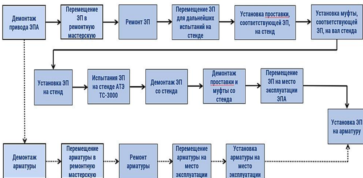
Рисунок 1 – Существующая технология капитального ремонта ЭПА
