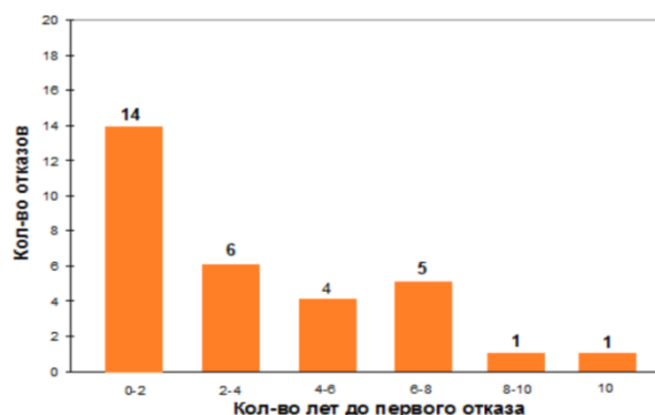
Рисунок 3 – Зависимость частоты отказов от времени эксплуатации теплообменников Машинпэкс
