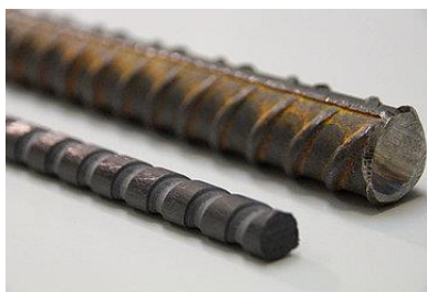
Рисунок 1 – Сравнение углеродного арматурного стержня и стального (углеродный представлен слева, стальной – справа)
