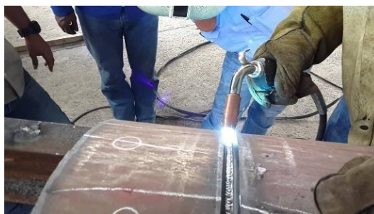
Рисунок 2 – Механизированная сварка плавящимся электродом в среде активных газов и смесях
