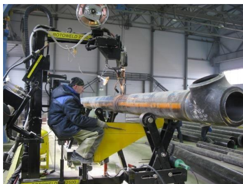
Рисунок 3 – Орбитальная сварочная установка
