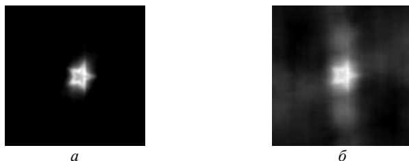
Рис. 1. Вид корреляционного поля: для изображения из истинного класса (а), для изображения из ложного класса (б)
