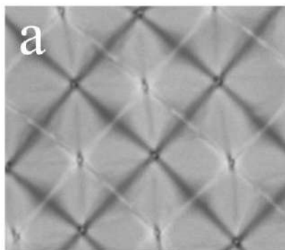
Рис. 1. Вид двумерного фотонного кристалла в проходящем свете
