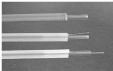
Рис. 2. Волоконные датчики температуры и деформации
