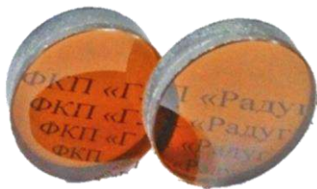
Рис. 2. Образец высокопрозрачная композитная лазерная керамика (ВПКЛК) Nd:YAG/Cr:YAG
