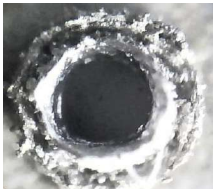
Рис. 1. Внешний вид кратера на поверхности мишени
