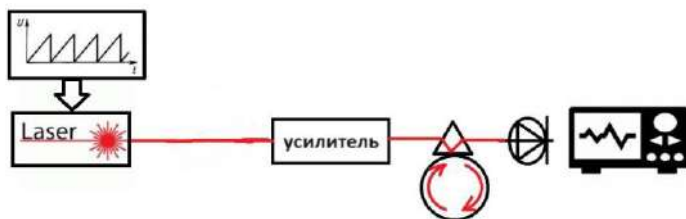
Рис. 1. Схема экспериментальной установки для измерения сдвигов частоты
