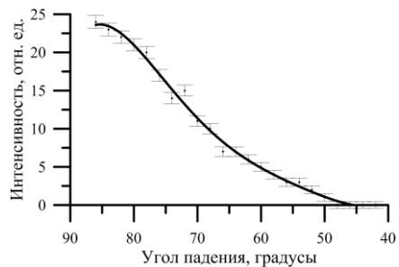
Рис. 2. Интенсивность на выходе фибера при варьировании угла падения света ( \lambda_0 = 532 нм) на его входной торец, полученная экспериментально
