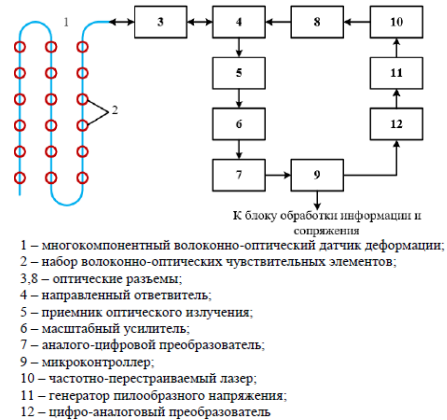
Рис. 1. Функциональная схема преобразователя
