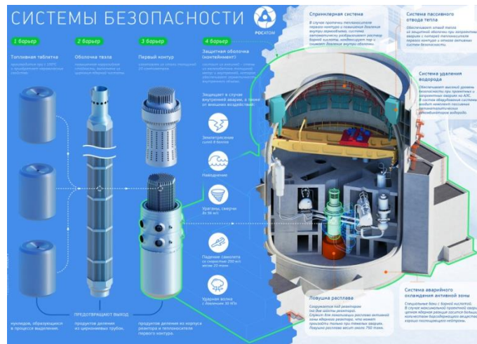
Рисунок 1- Системы безопасности российских АЭС (Росатом) [2]
